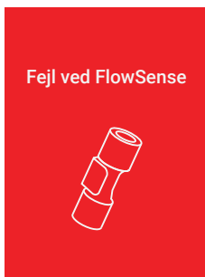
Alarmskærm »Fejl ved FlowSense«
